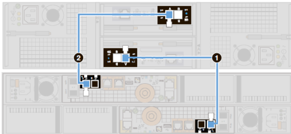
Рисунок 35. Пример: подключение процессорной полки с дисками к дисковой полке 0 шины BE1; подключение процессорной полки с дисками к 25-дисковой полке с помощью кабеля SAS.
