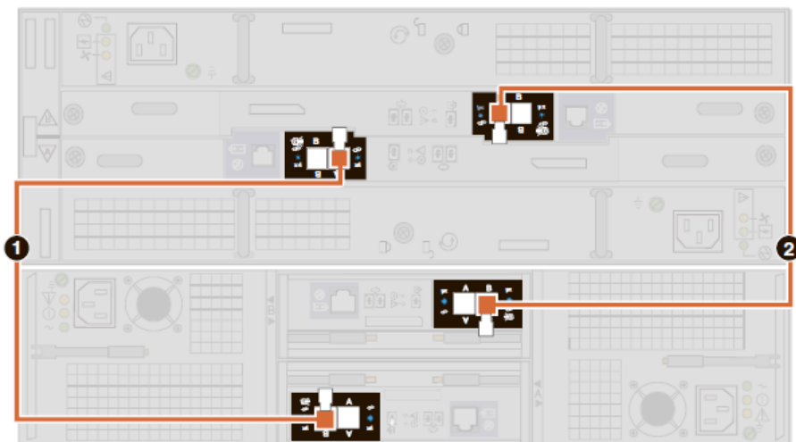
Рисунок 40. Пример: расширение внутренней шины SAS путем подключения новой дисковой полки.
