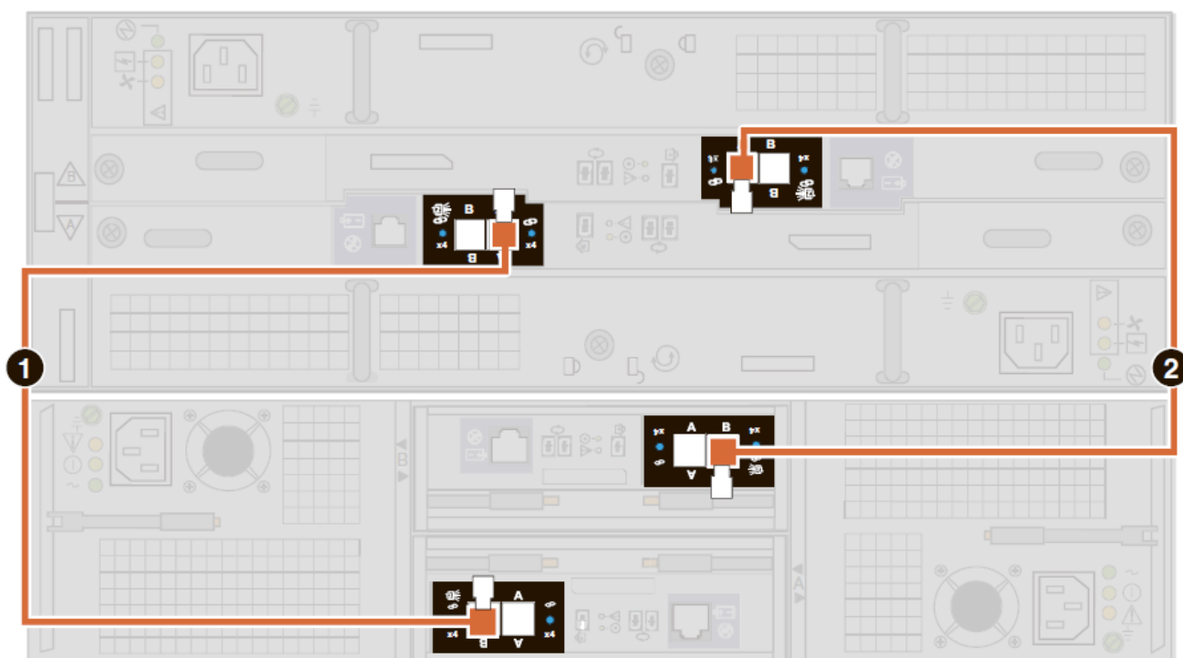
Рисунок 32. Расширение внутренней шины SAS путем подключения новой дисковой полки.
