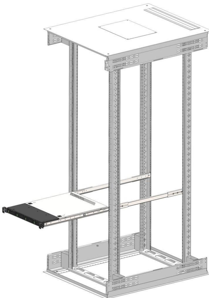
Рисунок 12. Монтаж шасси в стойку
